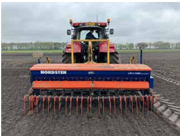
Foto 5.1 Drie verschillende zaaimachines en een voorbeeld van grondbewerking en zaaien in één werkgang: linksboven een precisiezaaimachine (rijenafstand 37.5cm), rechtsboven een pneumatische zaaimachine (rijenafstand 25cm), linksonder een nokkenradzaaimachine (rijenafstand 26.5cm) en rechts onderin een combinatie van rotorkoep en precisiezaaimachine (foto's: WUR).
