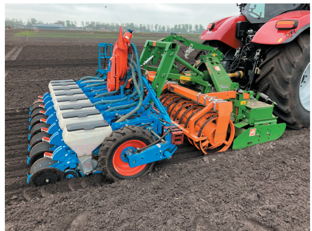
Foto 5.1 Drie verschillende zaaimachines en een voorbeeld van grondbewerking en zaaien in één werkgang: linksboven een precisiezaaimachine (rijenafstand 37.5cm), rechtsboven een pneumatische zaaimachine (rijenafstand 25cm), linksonder een nokkenradzaaimachine (rijenafstand 26.5cm) en rechts onderin een combinatie van rotorkoepel en precisiezaaimachine (foto's: WUR).
